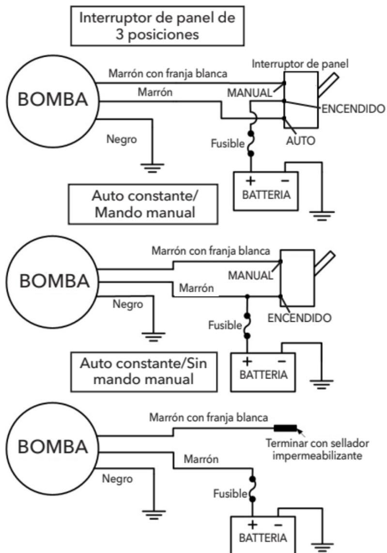
**Para la bomba de 12 voltios:** Voltaje mínimo requerido de 10,5 voltios.
