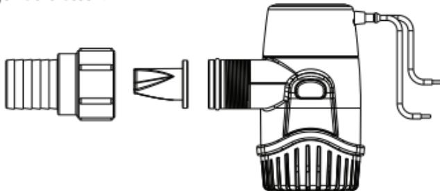
Die Lenzpumpe und das Rückschlagventil sind regelmäßig auszubauen, zu reinigen und auf Schäden zu überprüfen. Verschmutzungen im Bereich um diese Komponenten, die die Leistung der Pumpe beeinträchtigen können, müssen beseitigt werden.
