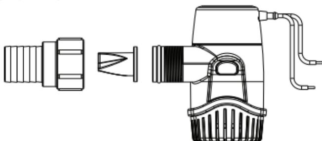
Desmonte, limpie e inspeccione la bomba de sentina, la válvula de retención y sus alrededores por si tuvieran daños o suciedad que pudieran reducir el rendimiento de la bomba.
