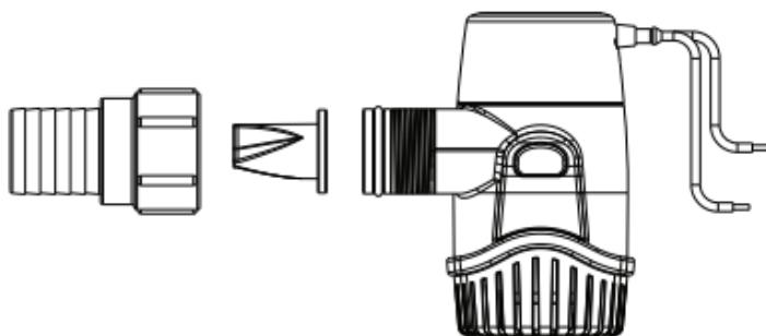
Ta regelbundet bort, rengör och inspektera länspump, backventil och området omkring så att där inte finns skador eller smuts, som kan försämra pumpens prestanda.
