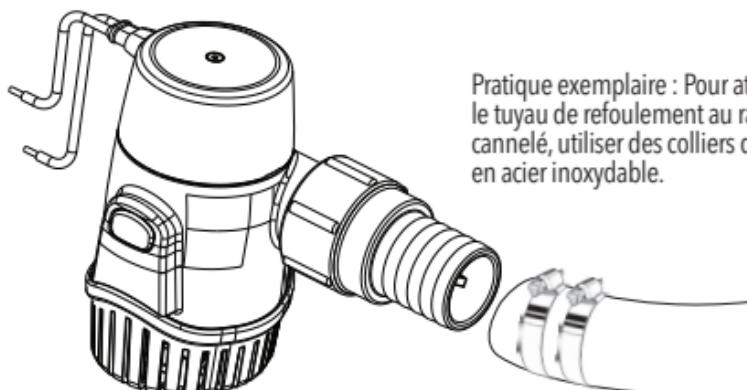
Pratique exemplaire : Pour attacher le tuyau de refoulement au raccord cannelé, utiliser des colliers de durite en acier inoxydable.
