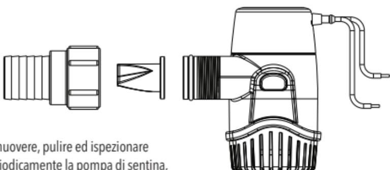
Rimuovere, pulire ed ispezionare periodicamente la pompa di sentina, la valvola di sfiato e lo spazio circostante per rilevare danni e presenza di residui che potrebbero ridurre le prestazioni della pompa.
