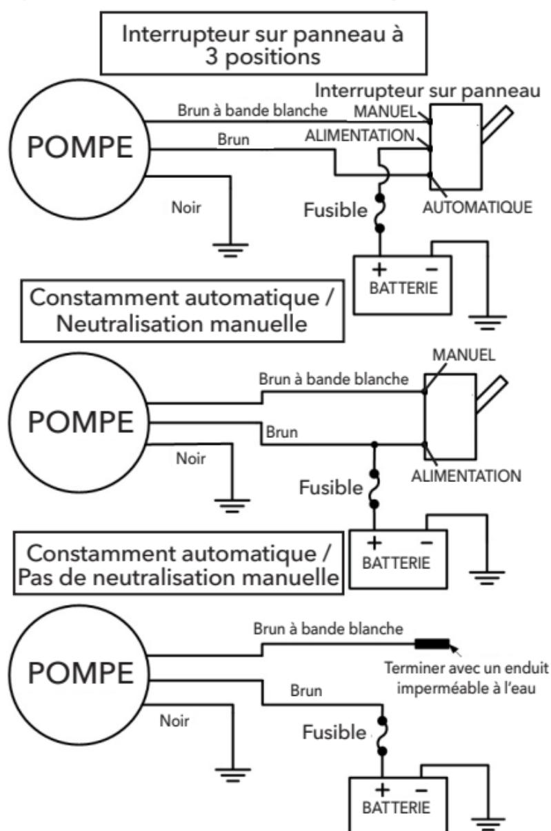
**Pour pompe 12 volts:** Tension minimum requis de 10,5 volts.
