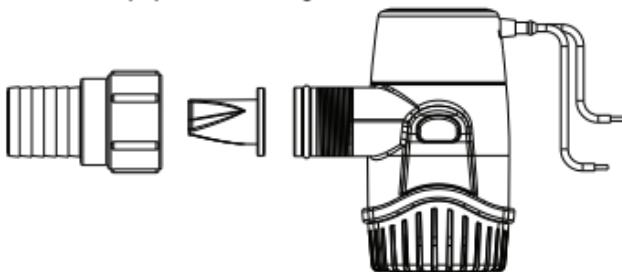
Enlever, nettoyer et inspecter périodiquement la pompe d'assèchement, le clapet antiretour et la zone environnante pour être certain qu'il n'y ait aucun dommage ou débris pouvant réduire le rendement de la pompe.
